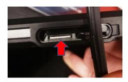
SHOWS THE SIM CARD LOCKED INTO PLACE
